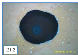
E1.2: Scatto eseguito a circa 5 cm da inizio foro: laterizio forato
